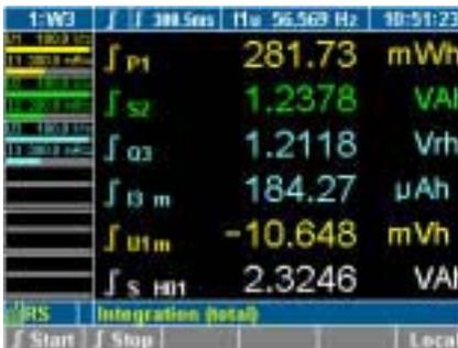
Gleichzeitige Darstellung von bis zu 6 frei konfigurierbaren Messwerten. Start/Stop Bedingung einstellbar. Anzeige der aufgenommenen bzw. abgegebenen Energie.
