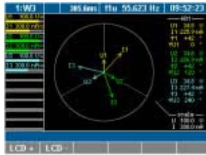
Vektordarstellung der HO1 von bis zu 6 Signalen. Zur einfachen Überprüfung des richtigen Anschlusses des Messgerätes und rascher Überblick über die Phasenwinkel der einzelnen Signale.
