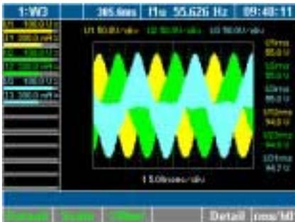
Gleichzeitige Darstellung von bis zu 3 Messwerten auf Ebene der Samples. Rascher Überblick über Kurvenform und Verzerrung.
